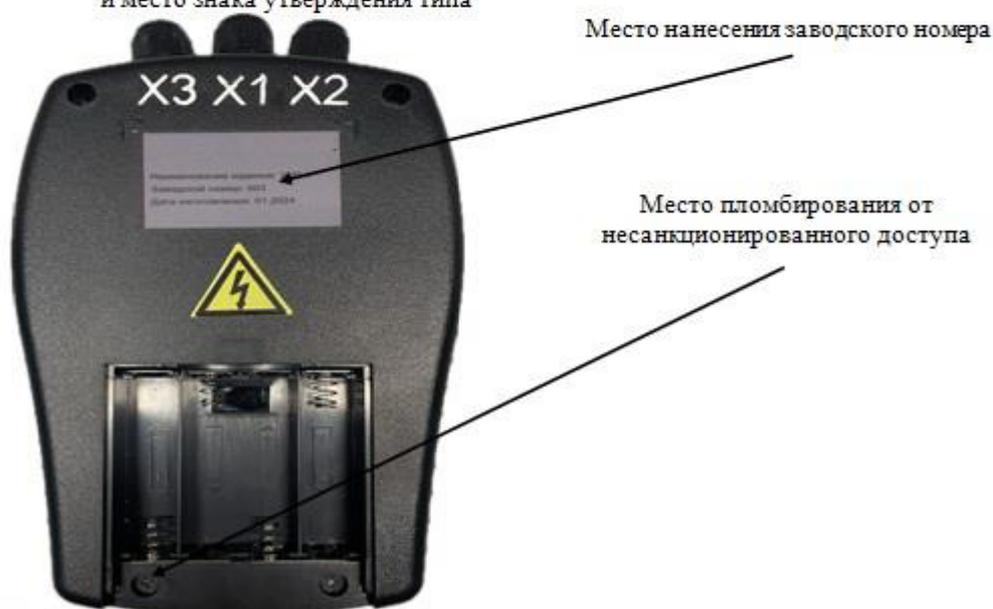
Рисунок 2 – Место нанесения заводского номера, пломбирования от несанкционированного доступа устройства контроля коммутирующего устройства УКП-1
