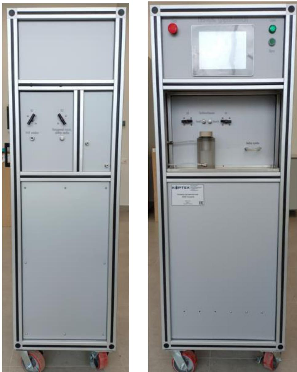
Рисунок 2 – Общий вид газометра с рамой из алюминиевого профиля с вентилями на задней панели ниши, ловушкой для улавливания капель жидкости.
