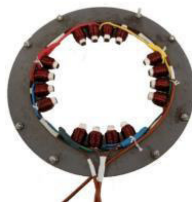
Рисунок 2 – Общий вид магнитопровода радиального датчика
