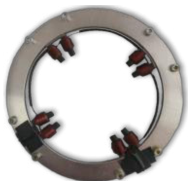
Рисунок 1 – Общий вид магнитопровода осевого датчика
