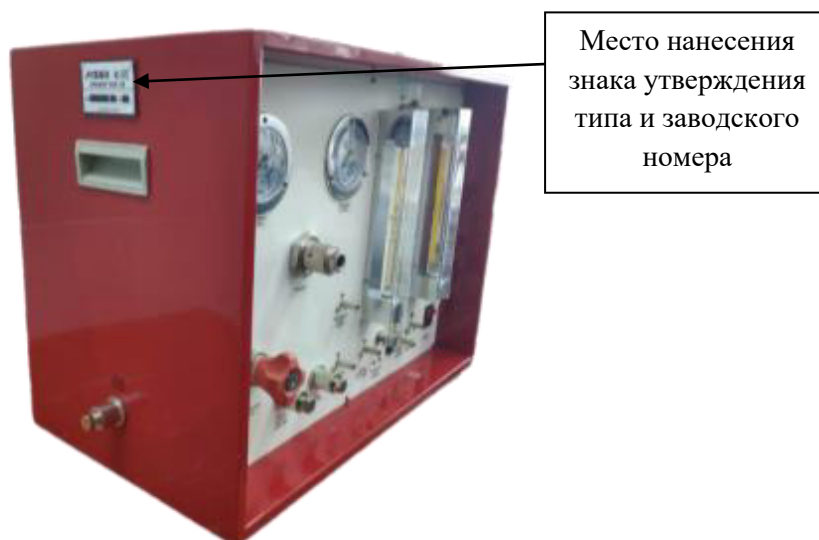
Рисунок 2 – Общий вид приборов УКП-5С с указанием места нанесения знака утверждения типа и места нанесения заводского номера
