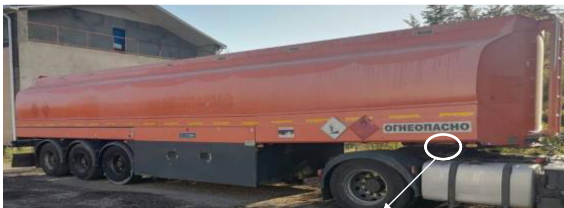
Рисунок 2 – Общий вид полуприцепа-цистерны EUROTANK ET-39-6 зав. № YF912V24SB5049890 и место нанесения заводского номера
