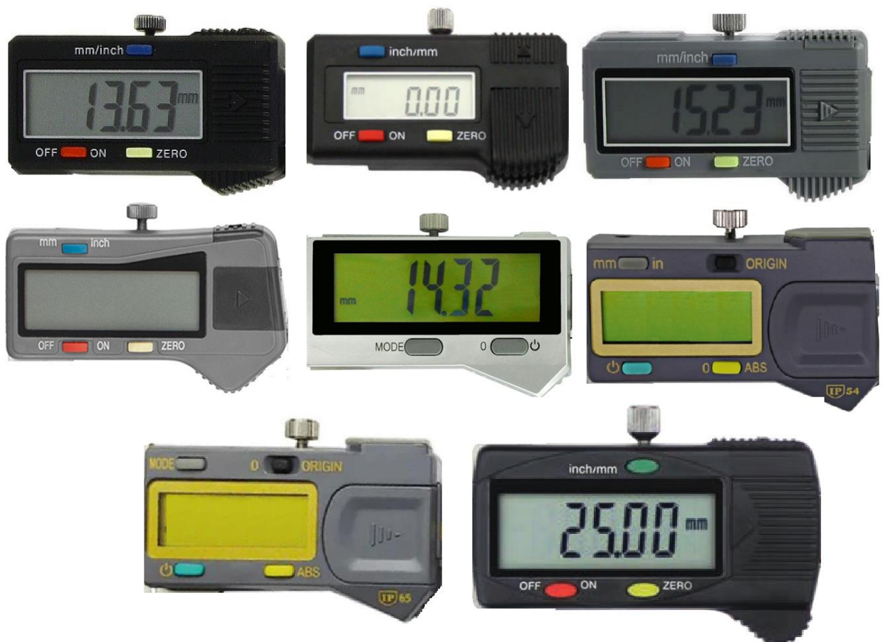
Рисунок 12 – Варианты исполнения цифрового отсчетного устройства для штангенглубиномеров модификаций ШГЦ и ШГПЦ
