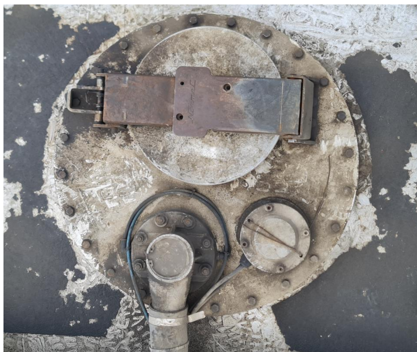
Рисунок 2 – Общий вид горловины автоцистерн 9534S1 ADR FL
