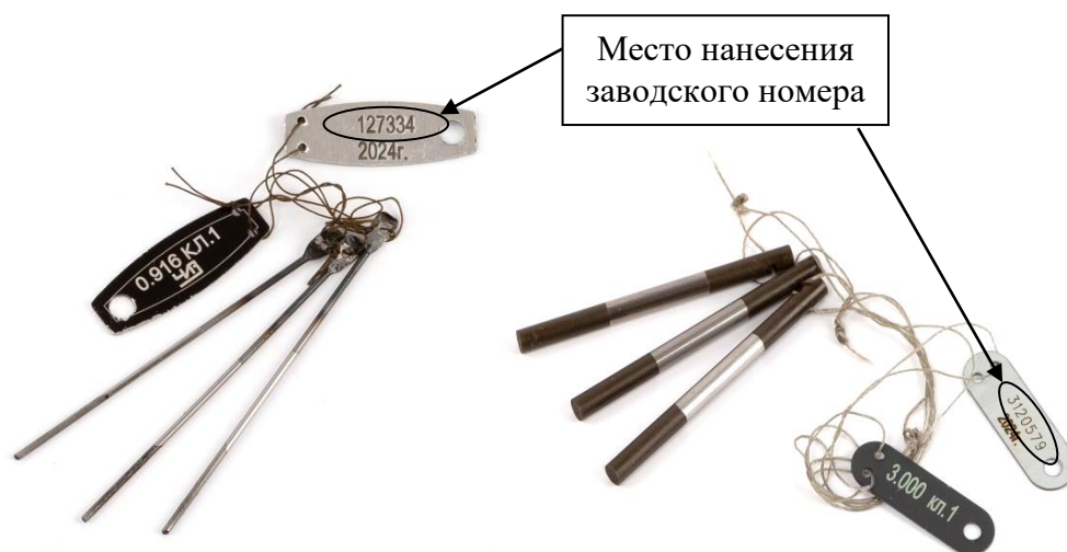
Рисунок 2 – Общий вид проволоочек ступенчатых типа II с указанием места нанесения заводского номера
