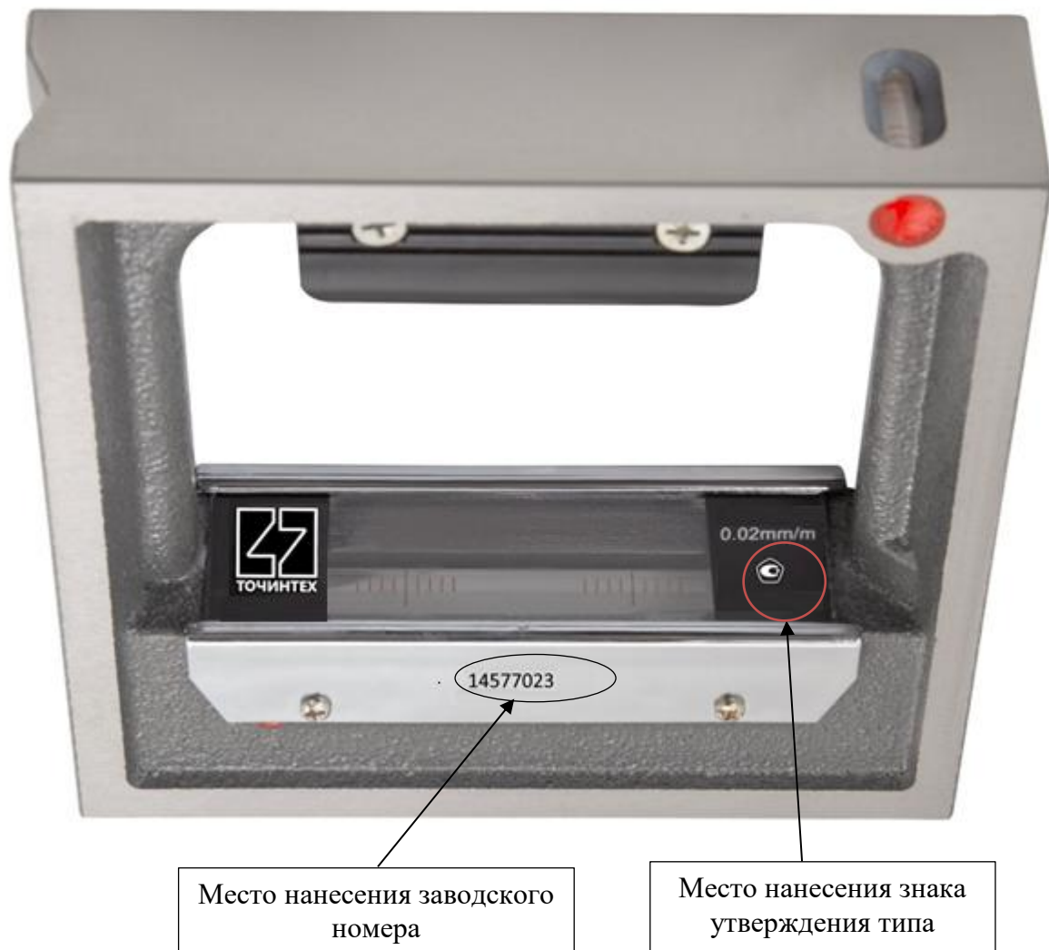
Рисунок 2 – Общий вид уровней рамных с указанием мест нанесения знака утверждения типа и заводского номера
