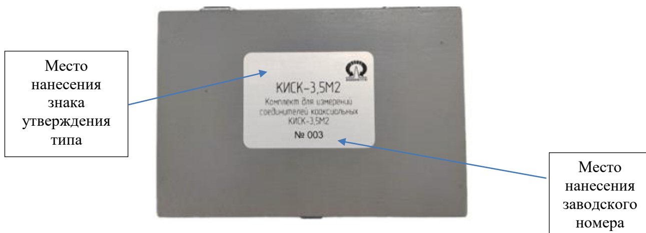
Рисунок 1 – Внешний вид комплекта КИСК-3,5М2 (в футляре) с обозначением мест нанесения знака утверждения типа и заводского номера
