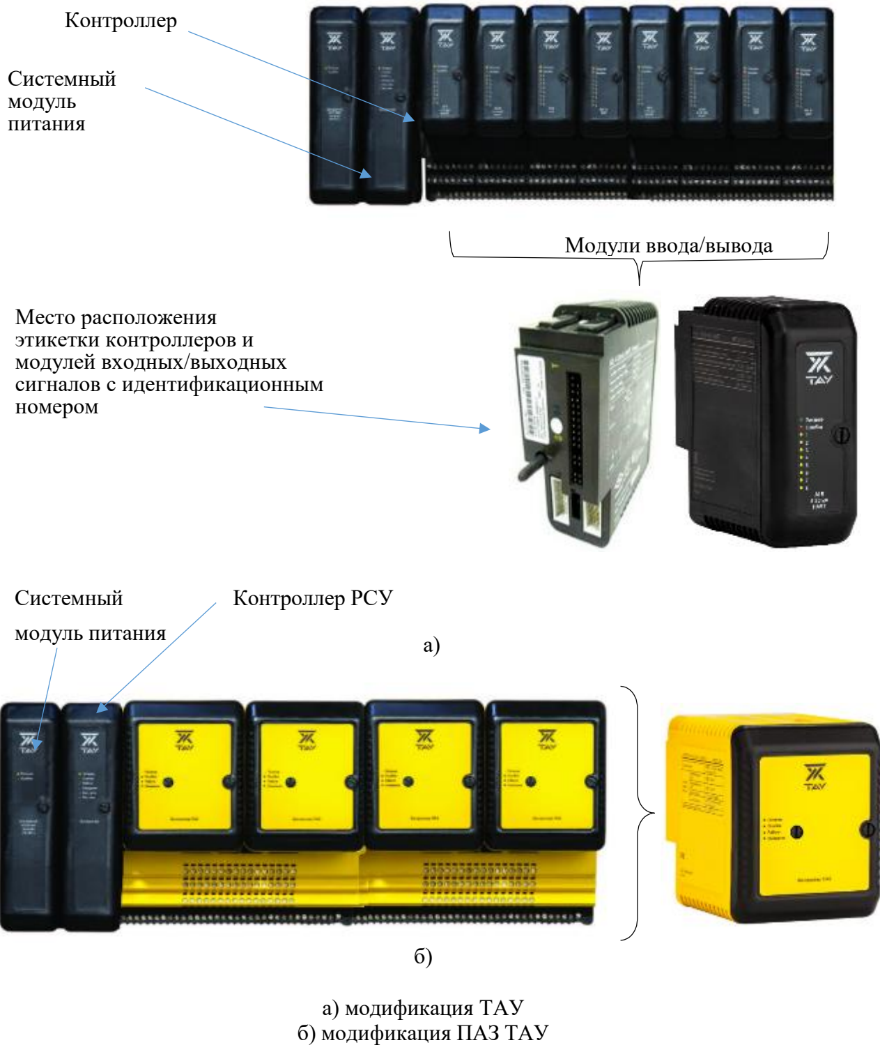
Рисунок 1 – Общий вид модулей питания, контроллеров и модулей входных/выходных сигналов комплексов с указанием мест нанесения этикетки контроллеров и модулей входных/выходных сигналов
