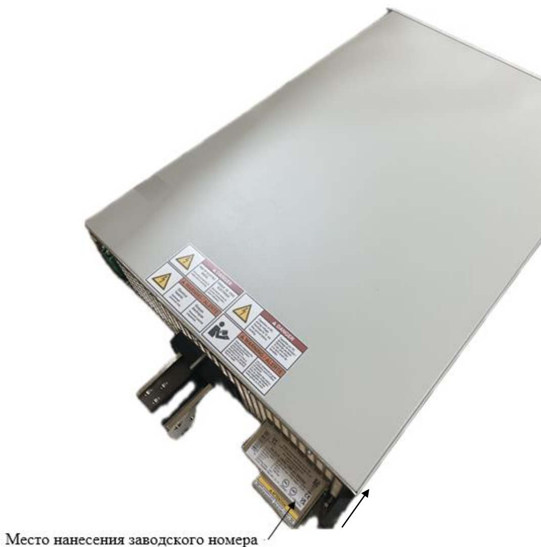
Рисунок 4 - Место нанесения заводского номера нагрузок EA-ELR 10080-1000 4U, EA-ELR 10200-420 4U, EA-ELR 10360-240 4U, EA-ELR 10500-180 4U, EA-ELR 10750-120 4U, EA-ELR 10920-125 4U, EA-ELR 11000-80 4U, EA-ELR 10080-170 3U, EA-ELR 10200-70 3U, EA-ELR 10360-40 3U, EA-ELR 10500-30 3U, EA-ELR 10750-20 3U, EA-ELR 10080-340 3U, EA-ELR 10200-140 3U, EA-ELR 10360-80 3U, EA-ELR 10500-60 3U, EA-ELR 10750-40 3U, EA-ELR 11000-30 3U, EA-ELR 10080-510 3U, EA-ELR 10200-210 3U, EA-ELR 10360-120 3U, EA-ELR 10500-90 3U, EA-ELR 10750-60 3U, EA-ELR 11000-40 3U, EA-ELR 10080-60 2U, EA-ELR 10200-25 2U, EA-ELR 10360-15 2U, EA-ELR 10500-10 2U, EA-ELR 10750-06 2U, EA-ELR 10080-120 2U, EA-ELR 10200-50 2U, EA-ELR 10360-30 2U, EA-ELR 10500-20 2U, EA-ELR 10750-12 2U, EA-ELR 11000-10 2U
