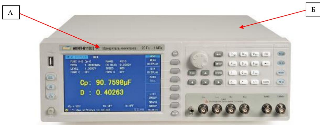
Рисунок 1 – Общий вид измерителей и место нанесения знака утверждения типа (А) и знака поверки (Б)
