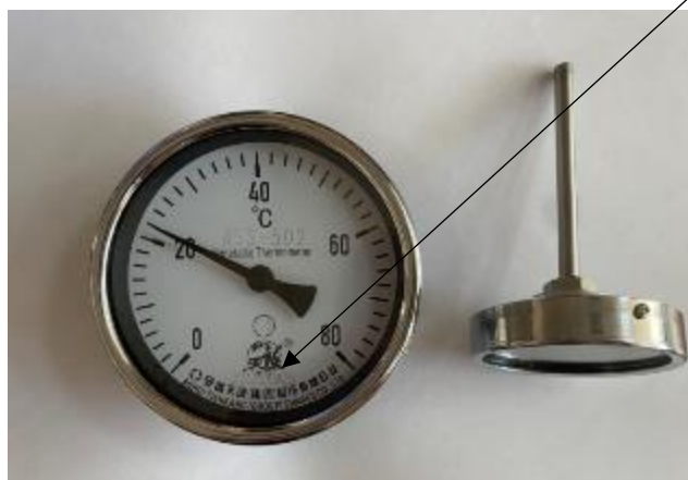
Рисунок 1 – Общий вид термометров биметаллических WS с указанием места нанесения заводского номера
