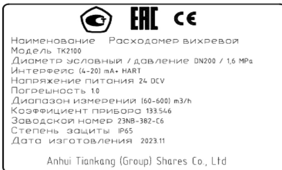
Рисунок 2 – Пример маркировочной таблички
