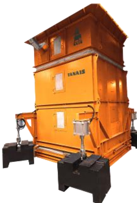
в) ГПУ средств измерений с элементами устройства самоконтроля
