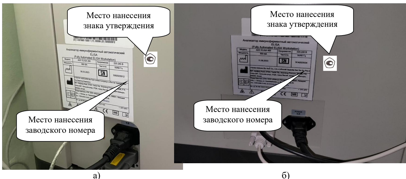
Рисунок 2 – Место нанесения заводского номера и знака утверждения типа, модель ADC ELISA 200 (а), модель ADC ELISA 400 (б)
