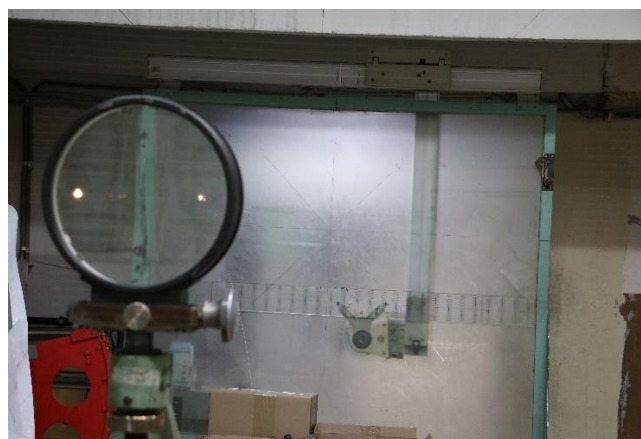
Рисунок 1 – Общий вид установки (слева - проектор, справа - компенсационный объектив и передвигающийся экран с пантографом и линейкой)
