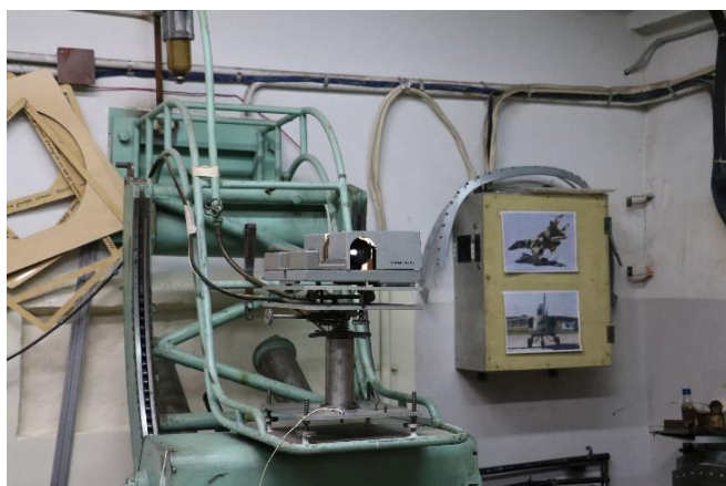
Рисунок 1 – Общий вид установки (слева - проектор, справа - компенсационный объектив и передвигающийся экран с пантографом и линейкой)
