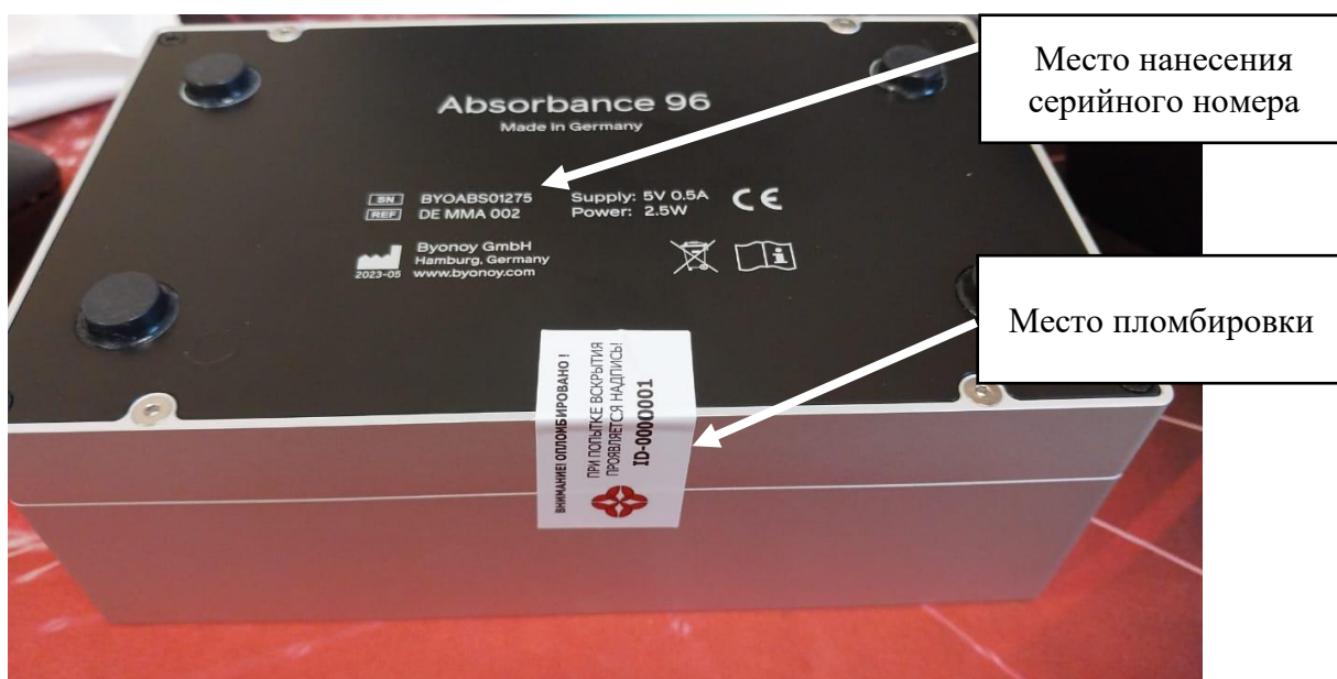
Рисунок 2 – Общий вид, схема маркировки и пломбировки фотометров
