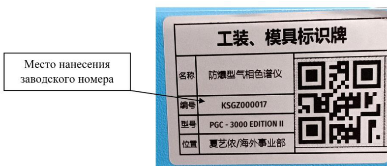
Рисунок 2 – Идентификационная табличка хроматографов с указанием места нанесения заводского номера
