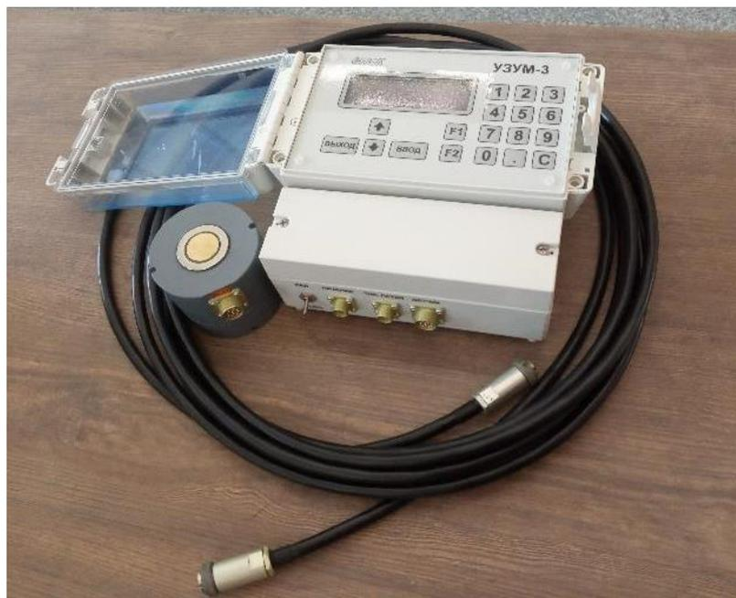
Рисунок 1 – Общий вид уровнемеров
