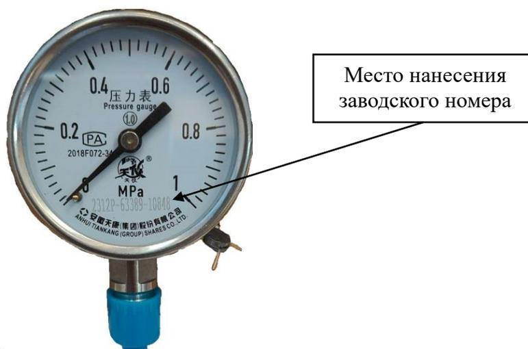
Рисунок 2 – Место нанесения заводского номера
