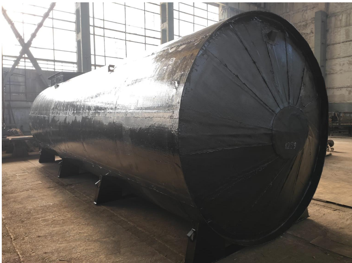
Рисунок 2 – Общий вид резервуара РГСДп-50
