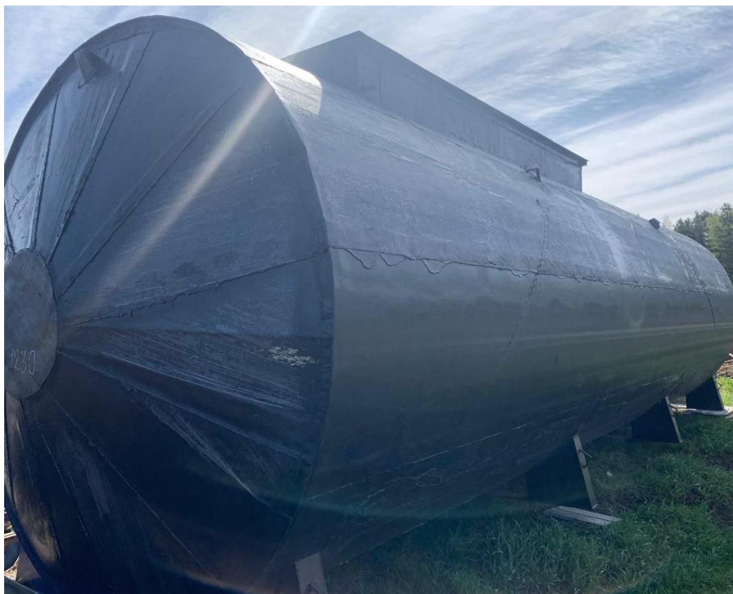
Рисунок 2 – Общий вид резервуаров РГСДп-50/2(35+15)
