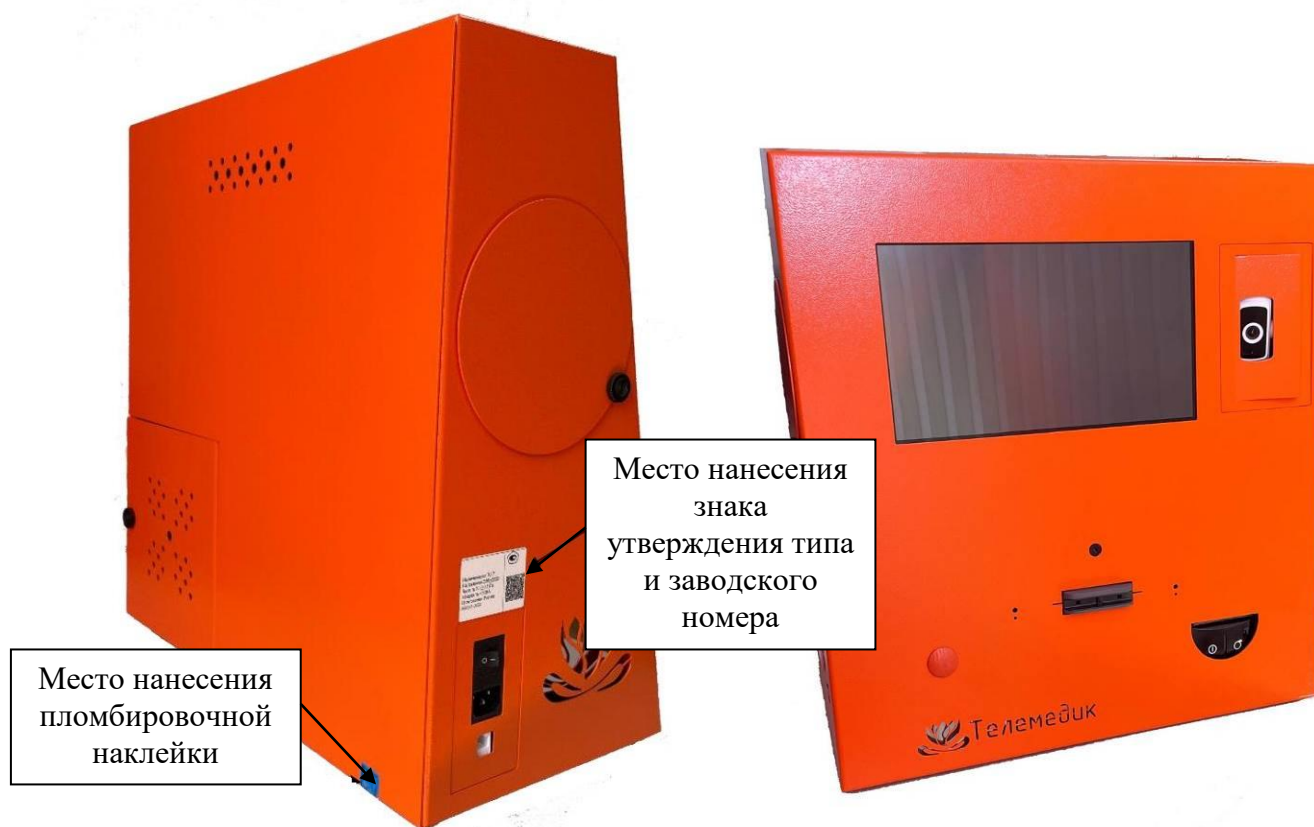
Рисунок 1 - Общий вид комплексов с указанием места ограничения доступа к местам настройки (регулировки), места нанесения знака утверждения типа, места нанесения заводского номера
