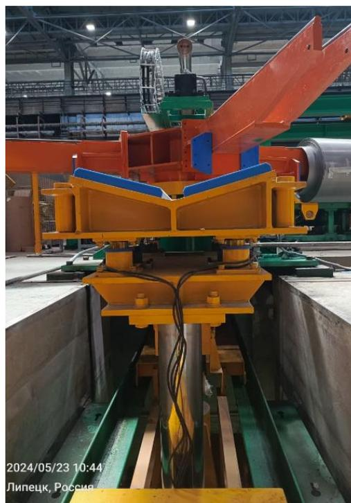
Рисунок 2 - Общий вид весов модификации ВРТ-1
