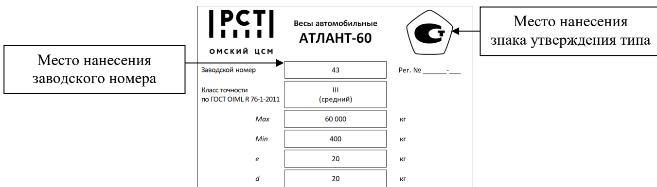
Р и с у н о к 2 – Общий вид маркировочной таблички с указанием мест нанесения заводского номера и знака утверждения типа
