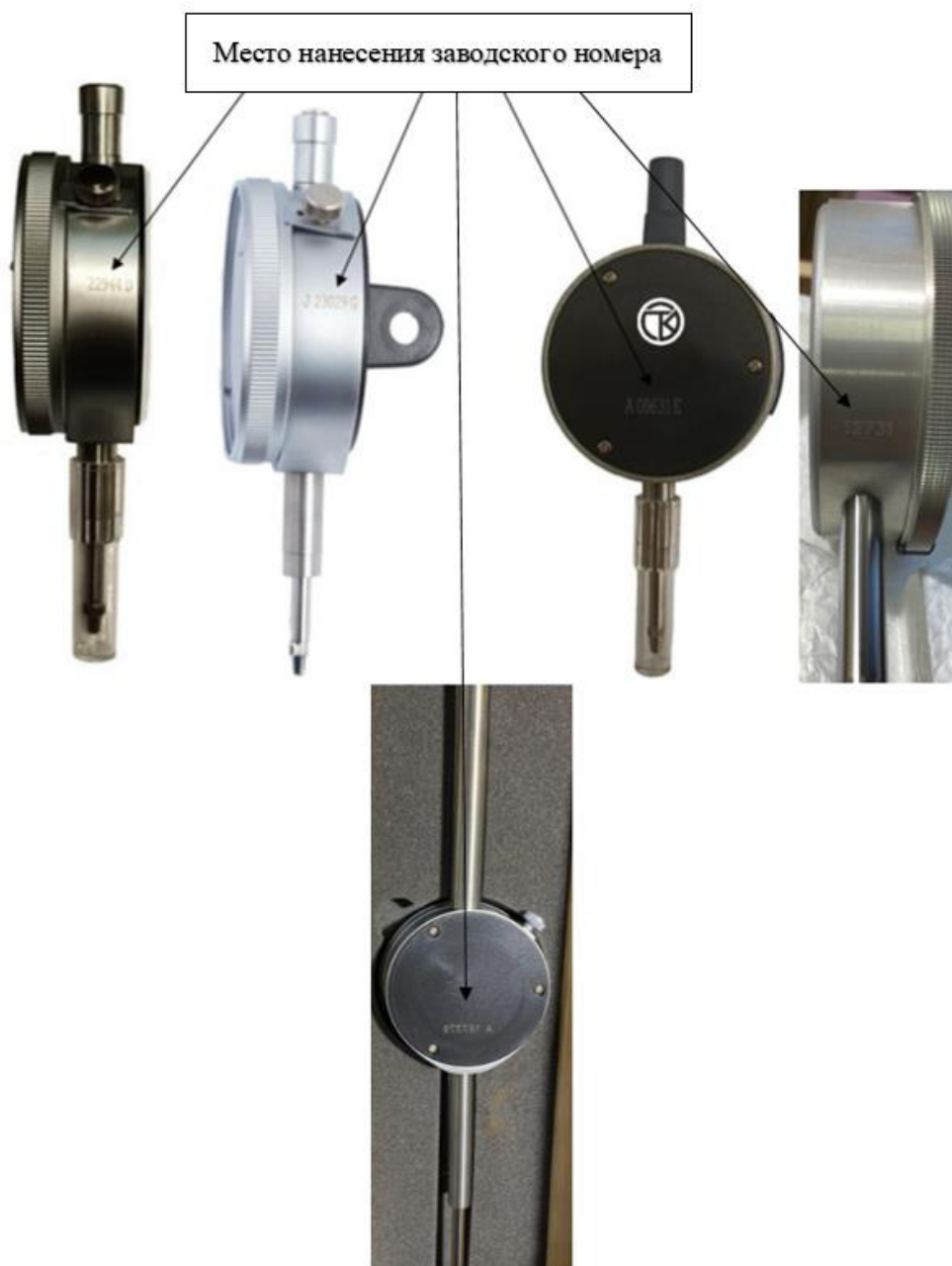
Рисунок 3 – Место нанесения заводского номера
