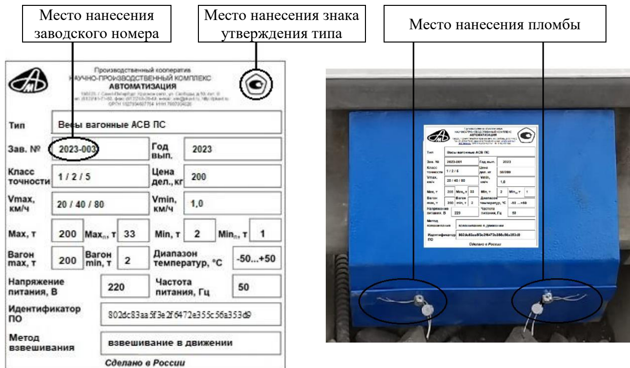
Рисунок 3 – Маркировочная табличка и АЦПД с пломбировкой
