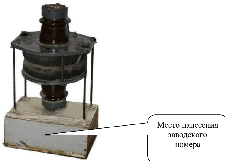
Рисунок 1 – Общий вид трансформатора тока с указанием места нанесения заводского номера
