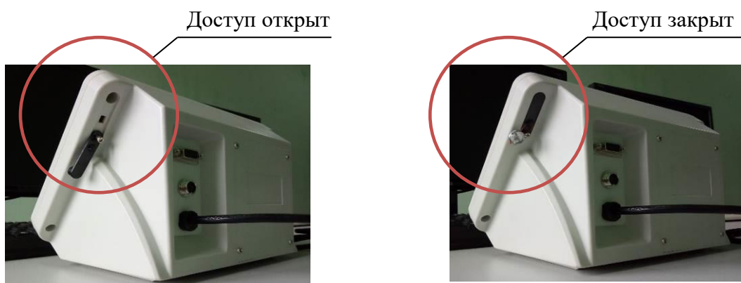
Рисунок 3 - Схема пломбировки приборов КСК от несанкционированного доступа
