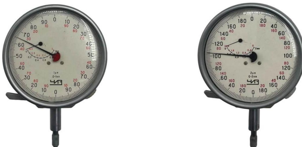
Рисунок 10 – Общий вид съемных отсчетных устройств модификации МИГ
