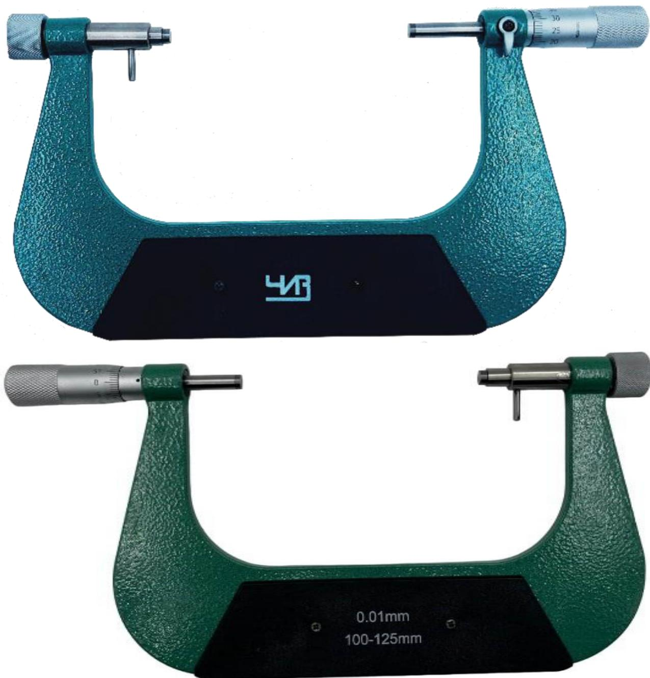
Рисунок 6 – Общий вид микрометров модификации МРИ и МРИ Ц без установленного (съемного) отсчетного устройства
