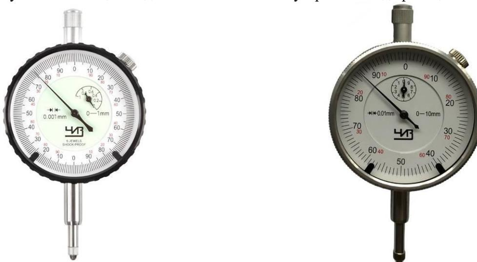
Рисунок 11 – Общий вид съемных отсчетных устройств модификации ИЧ
