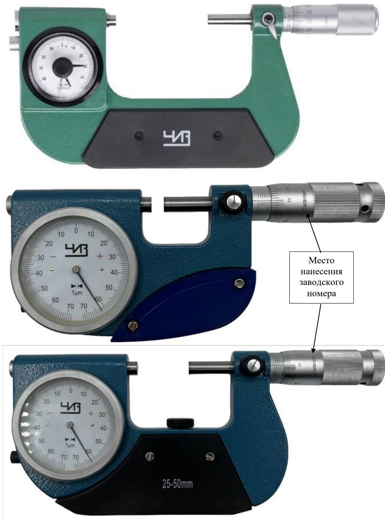
Рисунок 2 – Общий вид микрометров модификации МР
