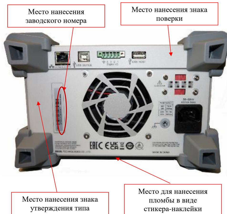
Рисунок 2 – Задняя панель источников
