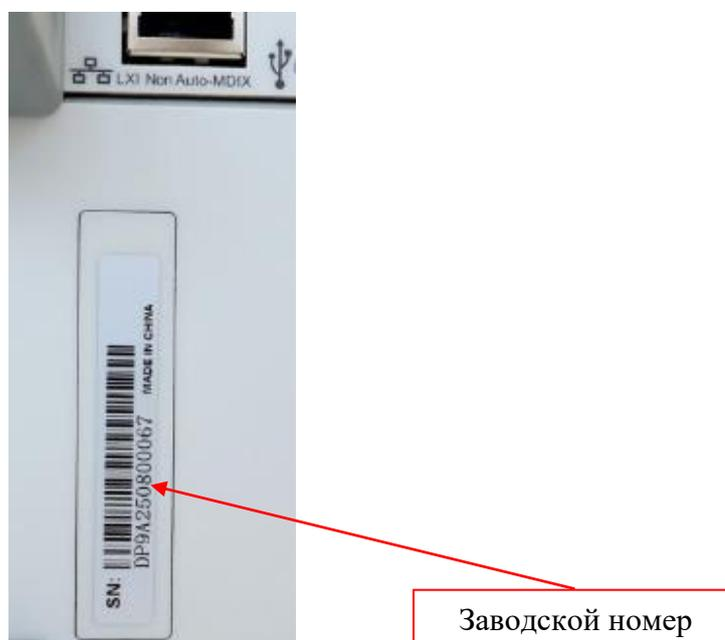
Рисунок 3 – Фрагмент задней панели источников с этикеткой
