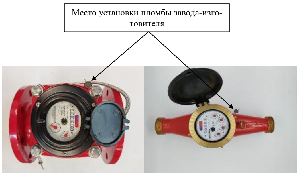
Рисунок 3 – Схема пломбировки от несанкционированного доступа
