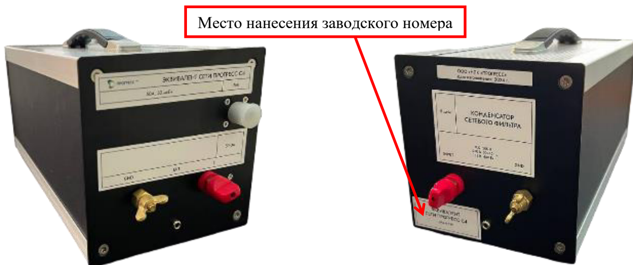
Рисунок 1 – Общий вид эквивалента сети ПРОГРЕСС-С4 вид спереди (слева), вид сзади (справа)
