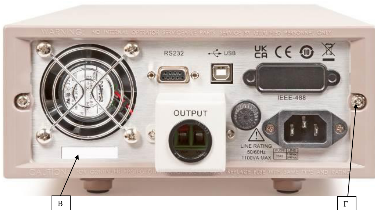
Рисунок 3 – Вид задней панели с местами нанесения серийного номера (В) и пломбировки от несанкционированного доступа (Г)
