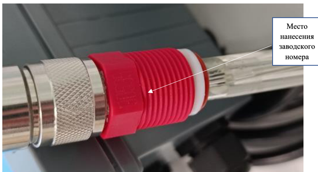
Рисунок 1г – Общий вид электрода pH/t с указанием места нанесения заводского номера
