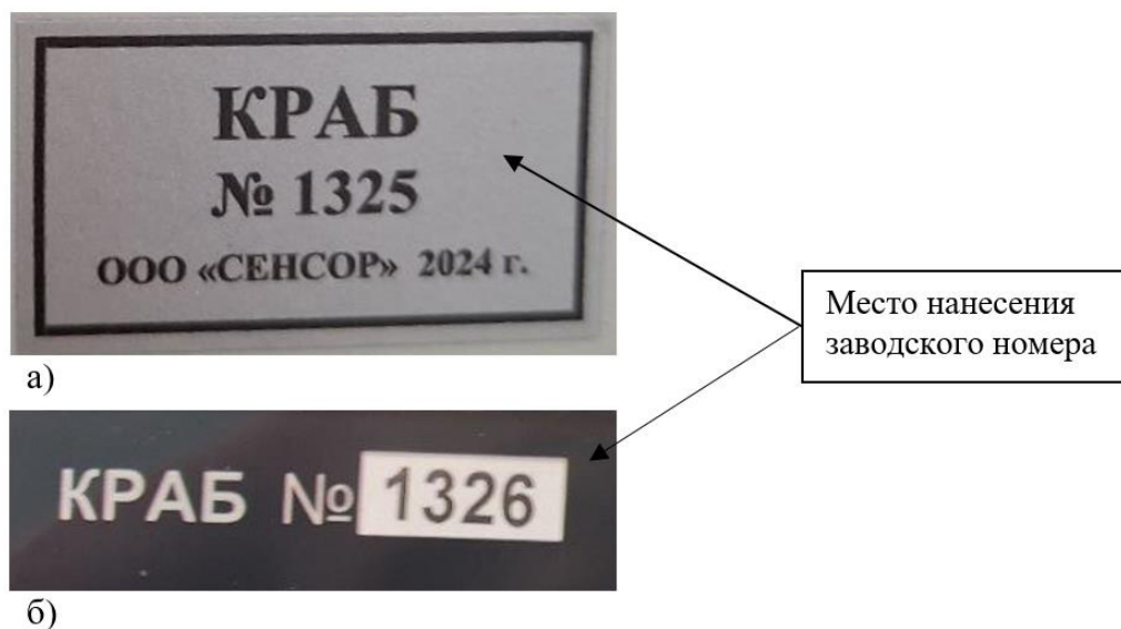
Рисунок 5 – Идентификационные таблички кондуктометров: а – измерительного блока кондуктометров настенного исполнения, б – измерительного блока кондуктометров щитового исполнения
