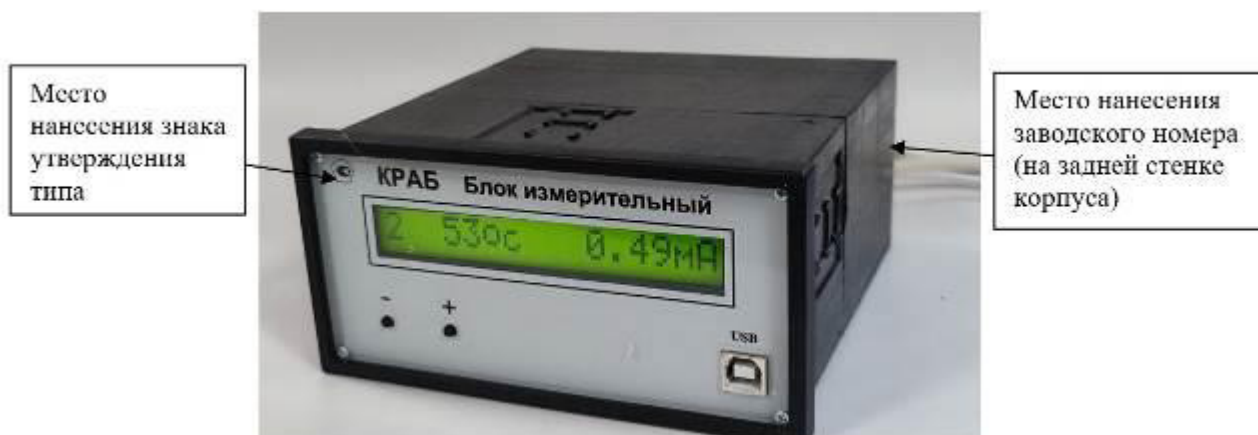
Рисунок 1 – Общий вид измерительного блока кондуктометров настенного исполнения с указанием места нанесения знака утверждения типа и заводского номера
