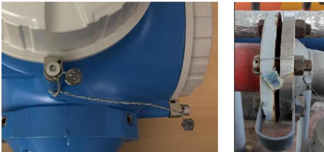
Рисунок 4 – Схема пломбировки от несанкционированного доступа, обозначение места нанесения знака поверки Promass 300 и Promass 83F
