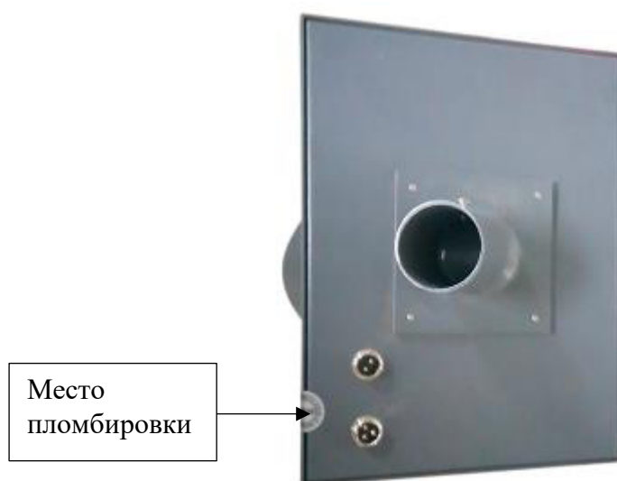
Рисунок 2 – Схема пломбировки от несанкционированного доступа для копров со способом управления с сенсорного дисплея и пульта оператора
