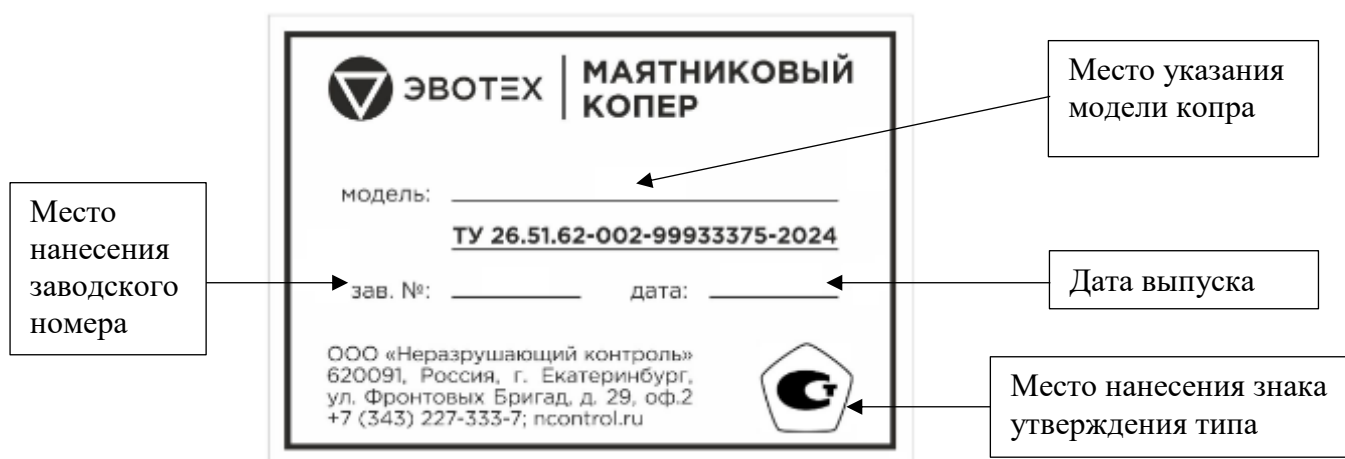
Рисунок 3 – Общий вид маркировочной таблички с обозначением места нанесения заводского номера и знака утверждения типа
