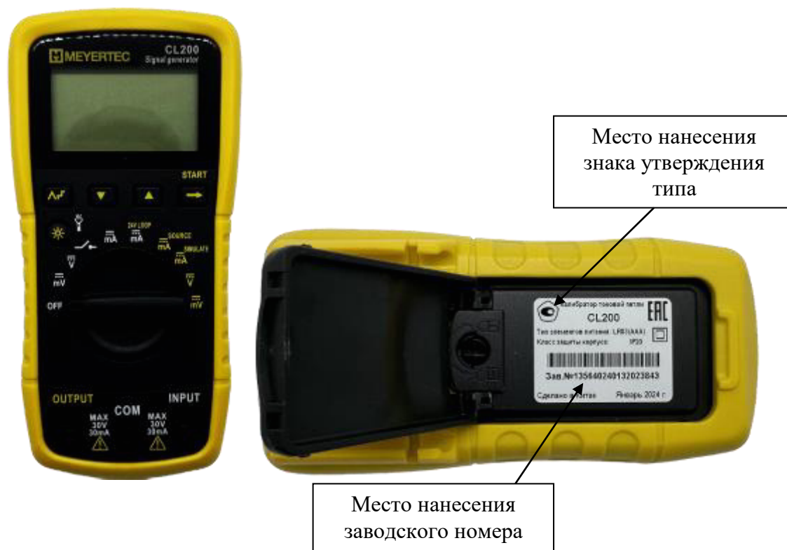
Рисунок 1 – Общий вид калибраторов с указанием места нанесения знака утверждения типа, места нанесения заводского номера
