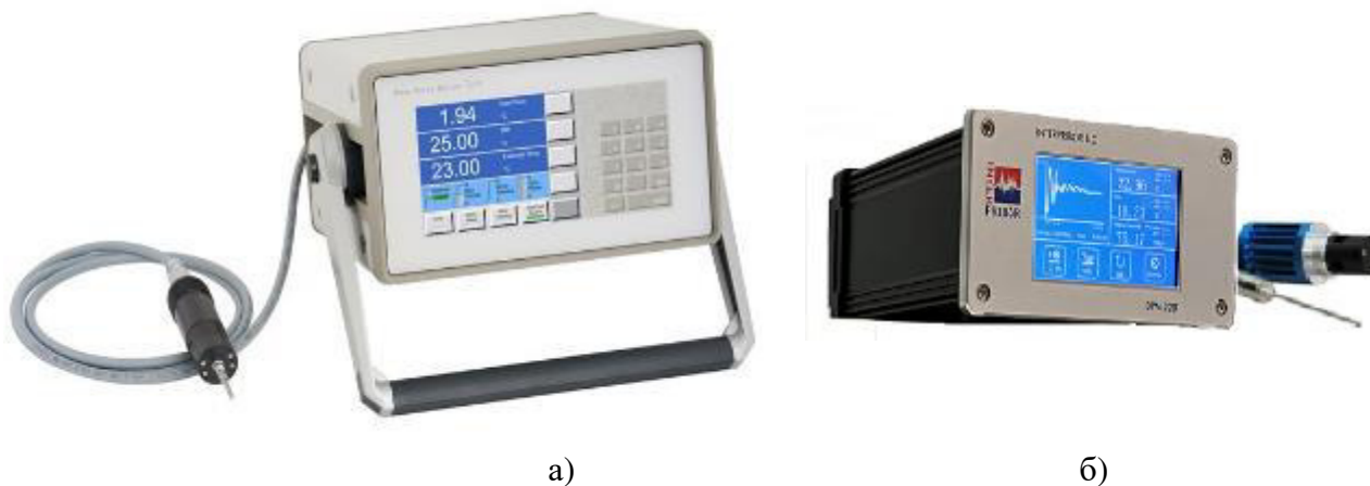
Рисунок 2 – Внешний вид БВГ 473-RP2 Dew Point Mirror (а) и БВГ DPM.2201 (б)
