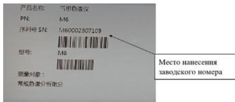
Рисунок 2 – Идентификационная табличка хроматографов
