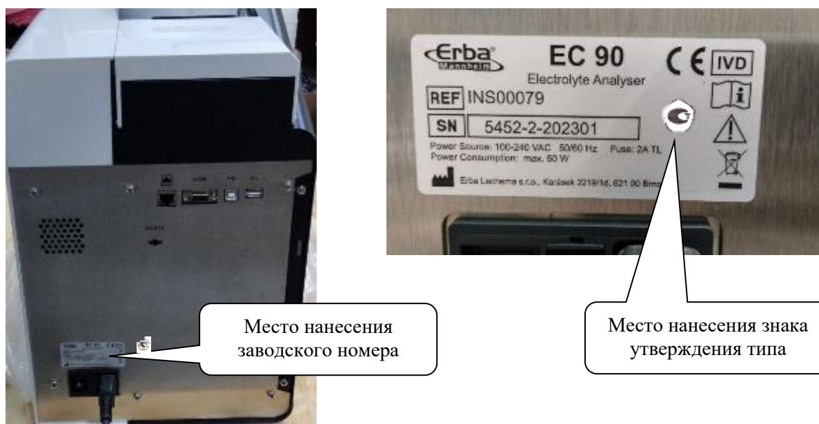
Рисунок 2 – Места нанесения заводского номера и знака утверждения типа
