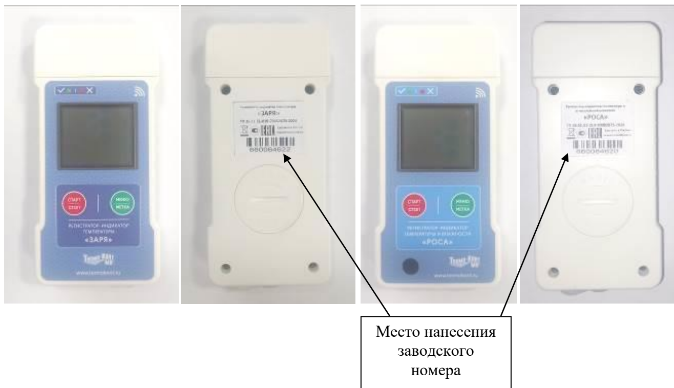
Рисунок 1 – Общий вид регистраторов-индикаторов Термо-Конт МК модификации «ЗАРЯ»
