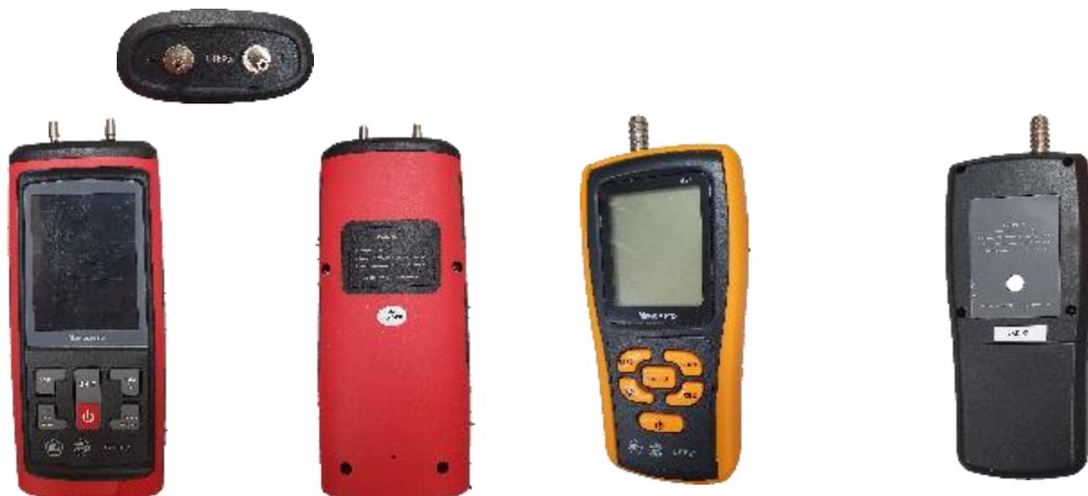
Рисунок 1 – Общий вид манометров портативных с указанием места нанесения заводского (серийного) номера
