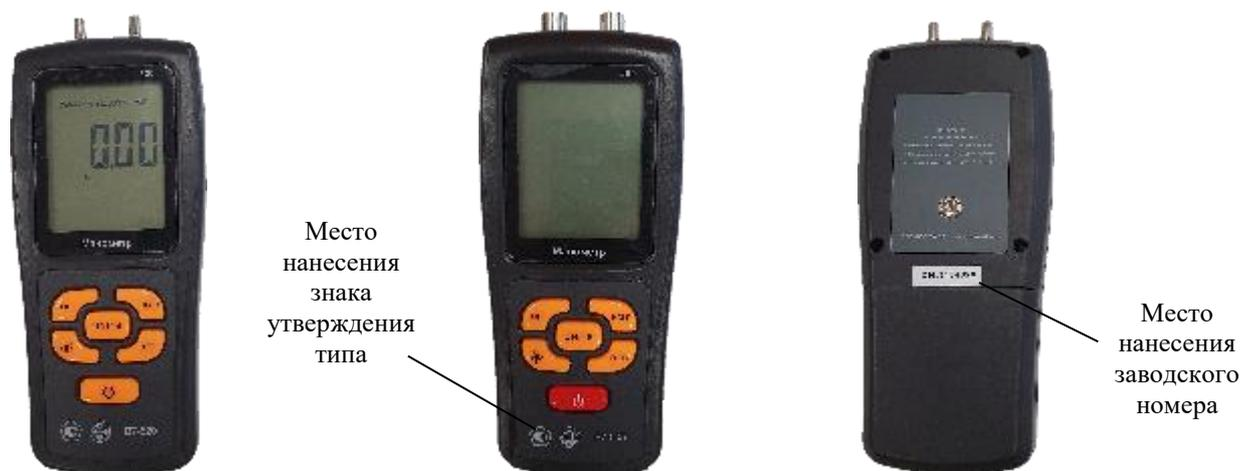
а) Манометры портативные разности давлений В7-505, В7-510, В7-511, В7-520, В7-522
