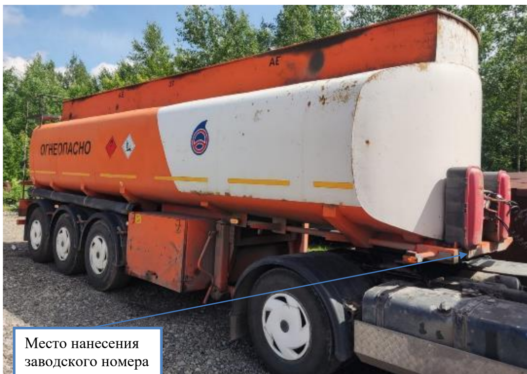
Рисунок 1 – Общий вид полуприцепа-цистерны 96392 зав.№ Х8996392G93АС6585 с указанием места нанесения заводского номера
