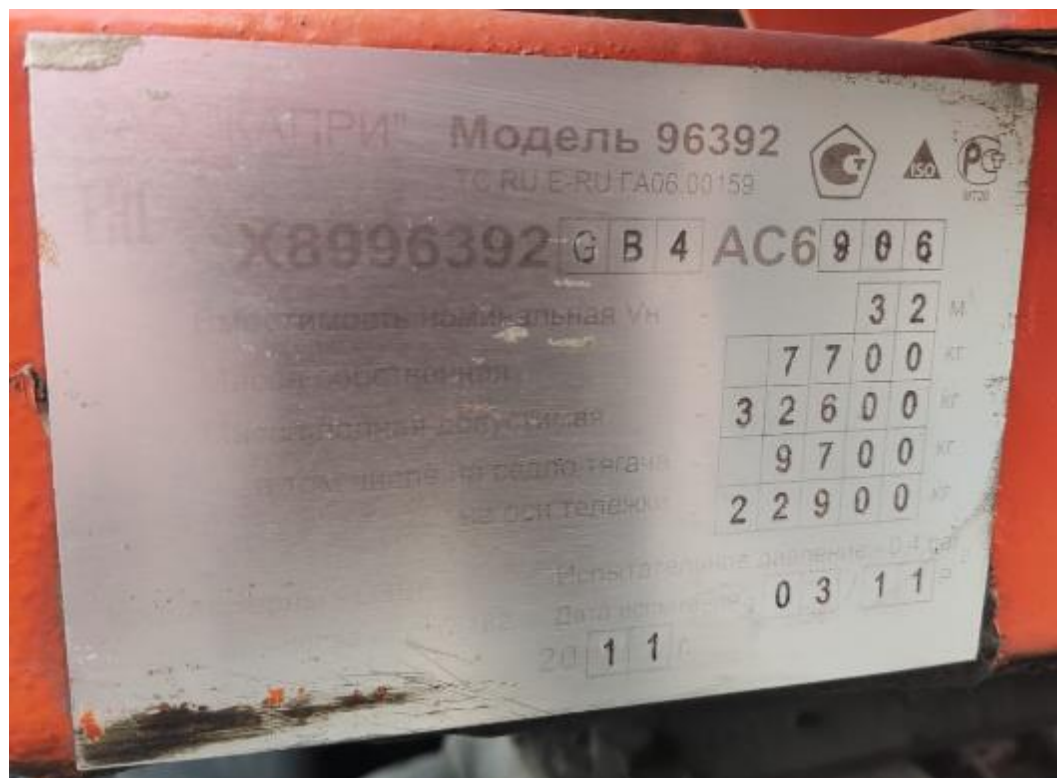
Рисунок 4 – Маркировочная табличка с заводским номером полуприцепа-цистерны 96392 зав.№ X8996392GB4AC6906
