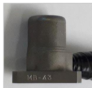
Рисунок 12 – Преобразователь виброускорения первичный МВ-43. Вид внешний
