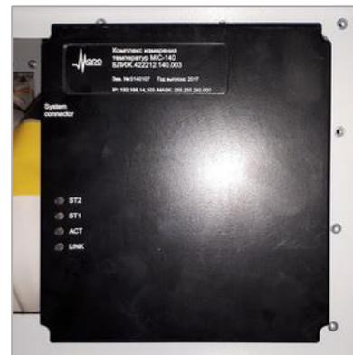
Рисунок 4 – Комплекс измерений температур МІС-140. Вид внешний
