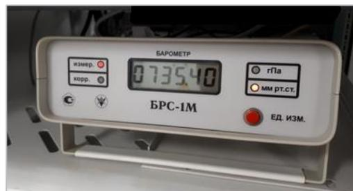
Рисунок 10 – Преобразователь давления абсолютного БРС-1М. Вид внешний
