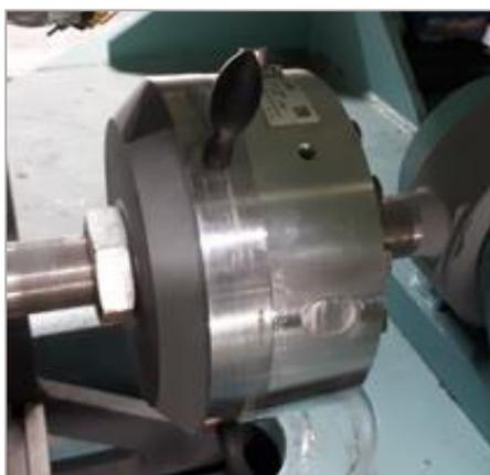
Рисунок 5 – Преобразователь силы первичный НВМ U10. Вид внешний
