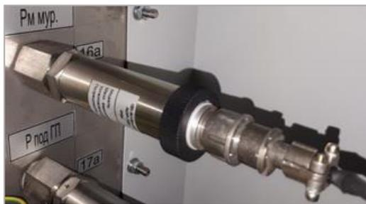
Рисунок 9 – Преобразователь давления первичный АИР-10. Вид внешний
