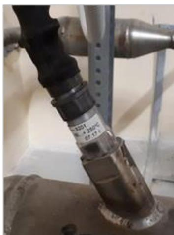
Рисунок 11 – Преобразователь температуры первичный ТП-9201. Вид внешний
