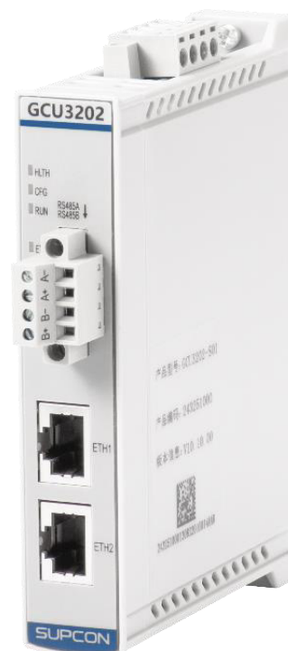
Рисунок 2 – Общий вид модулей с ЦПУ из состава контроллера
