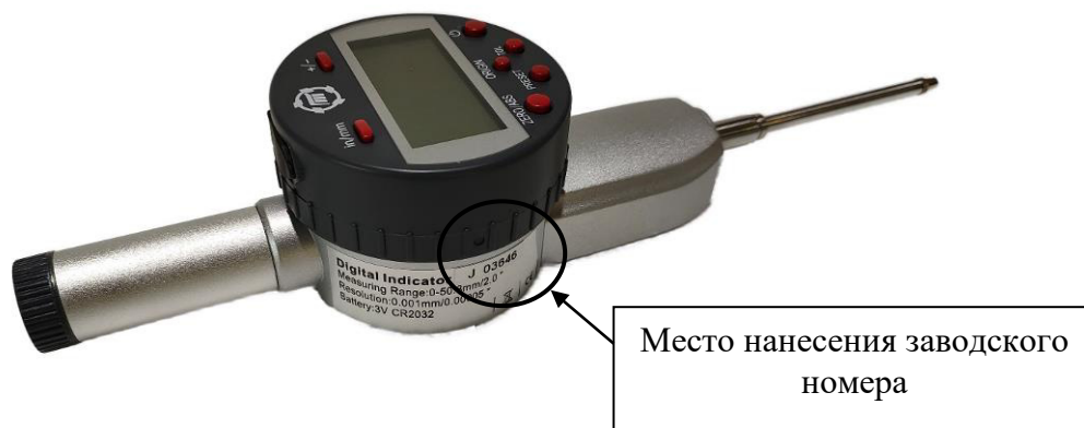
Рисунок 20 – Место нанесения заводского номера
